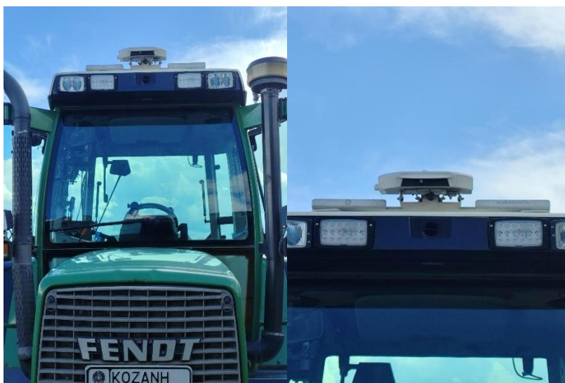
Εικόνα 13. Ο αισθητήρας Augmenta Field Analyzer τοποθετημένος στην οροφή του γεωργικού ελκυστήρα.
