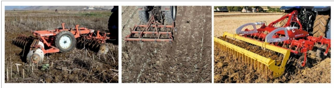
Εικόνα 4. Διατάραξη του εδάφους ανά κατηγορία κατεργασίας.
