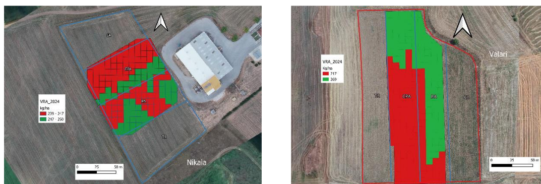
Εικόνα 15. Χάρτες εφαρμογής μεταβλητής λίπανσης σε καλλιέργεια σκληρού σίτου στην Νίκαια Λάρισας.
