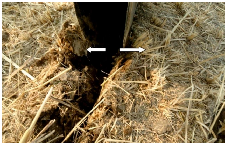
Εικόνα 7. Διάνοιξη αυλακιάς με διπλό δίσκο.
